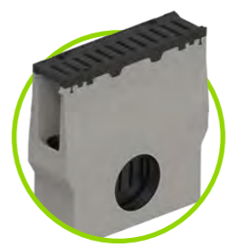
Unidad de sumidero, de una pieza, incl. rejilla de fundición dúctil, cubeta de sedimentos, salida DN 150
