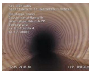
Videoinspección en tubo con interior color blanco
