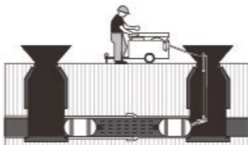
Figura 31. Colocación de tapones inflables para prueba de hermeticidad de campo
