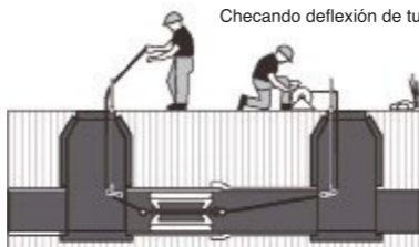
Figura 30. Prueba de paso de via deslizando un mandril
