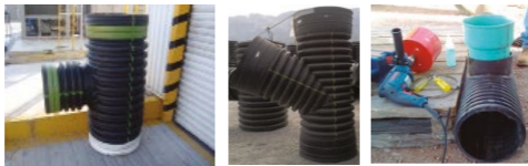
Figura 24. Ejemplo de conexiones fabricadas para drenaje pluvial
